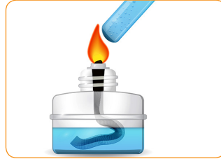
Sıvı yakıtın fitilde yükselmesi
